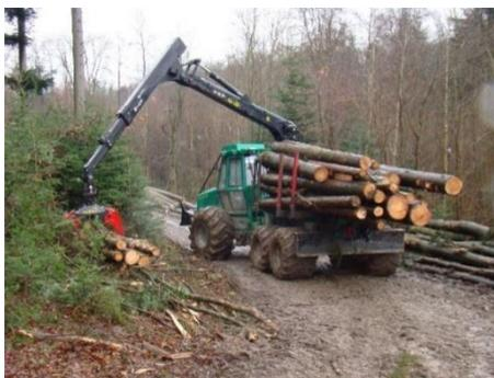
Dies ist eine Kombimaschine der Firma Noe. Dieser Maschinentyp vereint den Vorteil des Forwarders mit dem Rungenkorb mit jenem des Zangenschleppers mit Doppeltrommelwinde. Er hat aber den Nachteil der Fahrzeuglänge, wenn mit der Seilwinde gearbeitet wird. Zudem sind die Anschaffungskosten meist höher.
