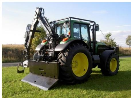
Hier ist ein Traktor mit einem Aufbau der Firma Kotschenreuther zu sehen. Dabei ist der Kran direkt am Traktor befestigt. Für den Rundholztransport kann ein Rungenwagen angehängt werden.
