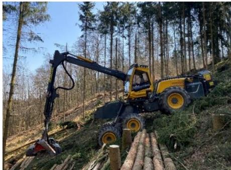
Dies ist ein Vollernter von EcoLog. Damit können Bäume vollmaschinell gefällt, entastet und abgelängt werden. Danach wird das Holz an der Rückegasse Sortimentsgetrennt abgelegt und der Forwarder rückt das Holz in einem separaten Arbeitsschritt an die Waldstrasse.
