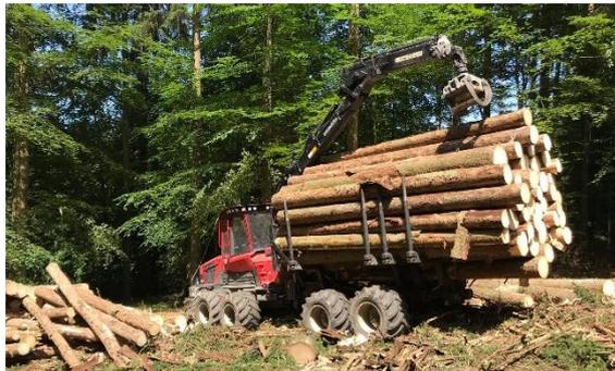
Dies ist ein Forwarder von Valmet. Damit werden die Baumstämme an der Rückegasse aufgeladen und an die Waldstrasse transportiert. Diese Maschine kann mit Traktionswinden auch im steilen Gelände fahren. Sie besitzt jedoch keine Seilwinde, um Bäume zu rücken. Mit der Traktionswinde wird die Maschine von einem Ankerpunkt aus im steilen Gelände abgeseilt.
