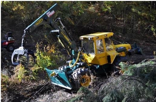
Dies ist ein Zangenschlepper von HSM. Damit können Bäume mit der Seilwinde, die ausserhalb der Reichweite des Krans liegen, an die Rückegasse gezogen werden. Zudem kann mit dem Kran und auf dem Heckschild Stammholz gerückt werden. Für den Rundholztransport auf der Strasse kann ein Rungenwagen angehängt werden. Diese Maschine ist geeignet, um im nicht fahrbaren Gelände von der Strasse oder der Rückegasse aus Holz zu ernten.
