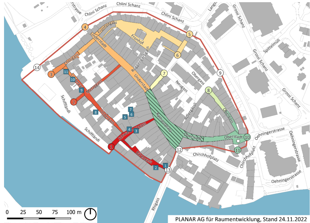
Abbildung 2: Erschliessungspunkte (Kreise) und dazugehörige Erschliessungsbereiche (flächig) sowie wesentliche über die Schiffländi erschlossene Anlieferpunkte (blaue Quadrate)
